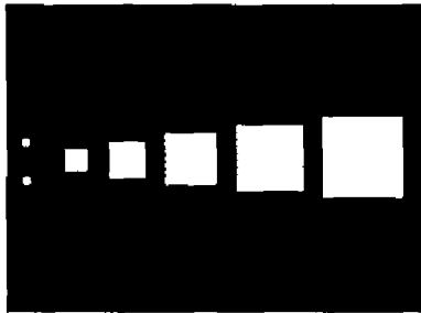
图6 腐蚀后的标准区域二值图像
