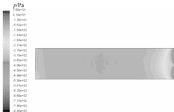
图6 屋顶风压力分布云图
