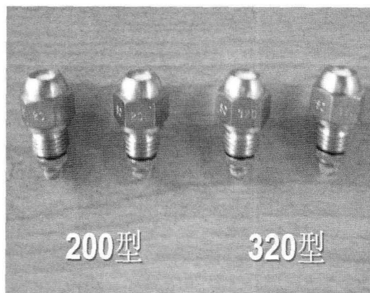
图4 喷雾试验的2种喷头
