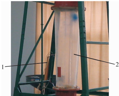
1:U 形管;2:锥形观察区。 图 1 PS-20 物料漂浮速度试验台 Fig. 1 PS-20 floating velocity test rig
