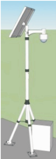
图 2 无线图像传感器节点的三维外观设计 Fig. 2 3D design of the wireless image sensor node
