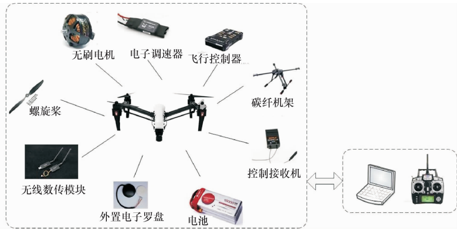
图 1 无人机试验平台组成图
