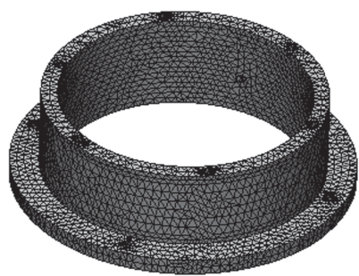
图 4 转盘的网格划分图 Fig. 4 Grid partition of the turntable
