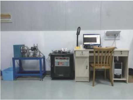
图 10 负载性能试验台 Fig. 10 Test platform of load performance
