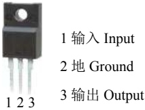
图 4 TO-220 封装引脚图 Fig. 4 Pin diagram of TO-220 encapsulation
