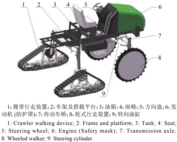
图 1 整机结构 Fig. 1 Structure of the whole machine
