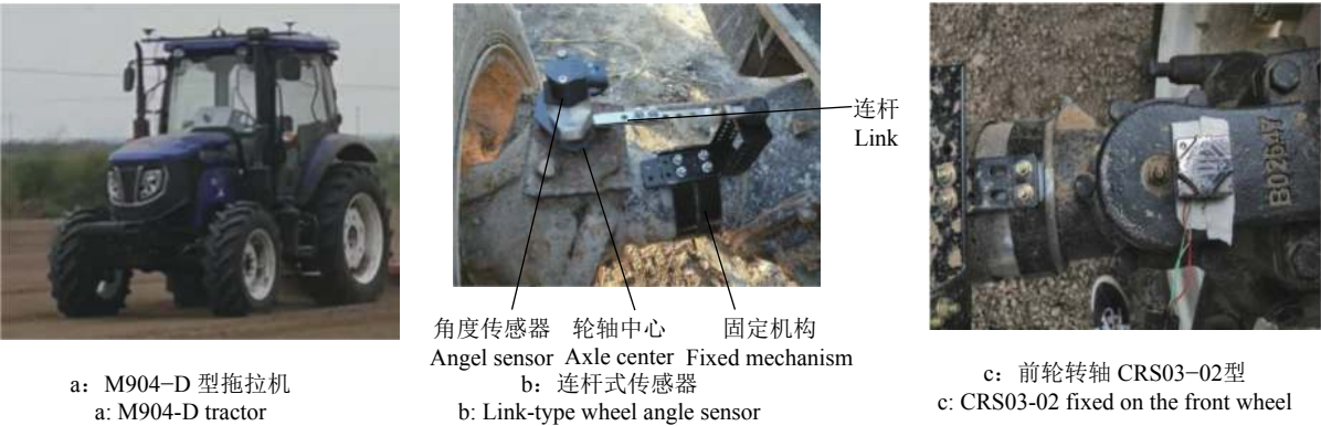
图 1 试验设备及安装示意图 Fig. 1 Test equipment and installation diagram
