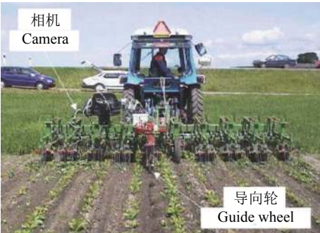
图 2 基于导向轮的除草机导航系统 Fig. 2 Navigation system of weeder based on guide wheel
