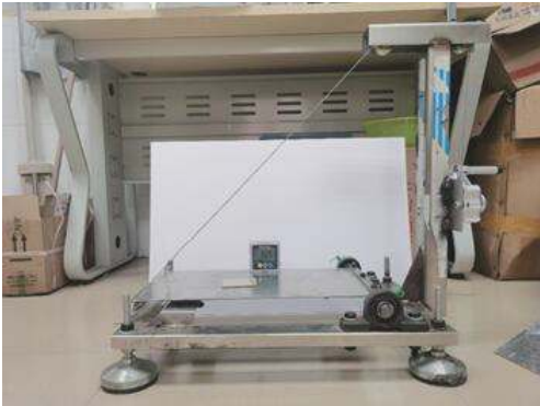
图 3 滑动摩擦角测试装置 Fig. 3 Sliding friction angle test device
