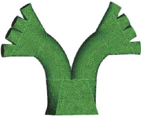
图 6 导风装置网格划分
