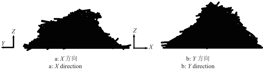
图 6 蔗段离散元仿真模型堆 Fig. 6 DEM simulation model stack of sugarcane segment
