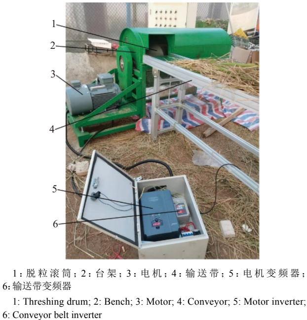
图 12 脱粒装置试验台 Fig. 12 Test bench of threshing device
