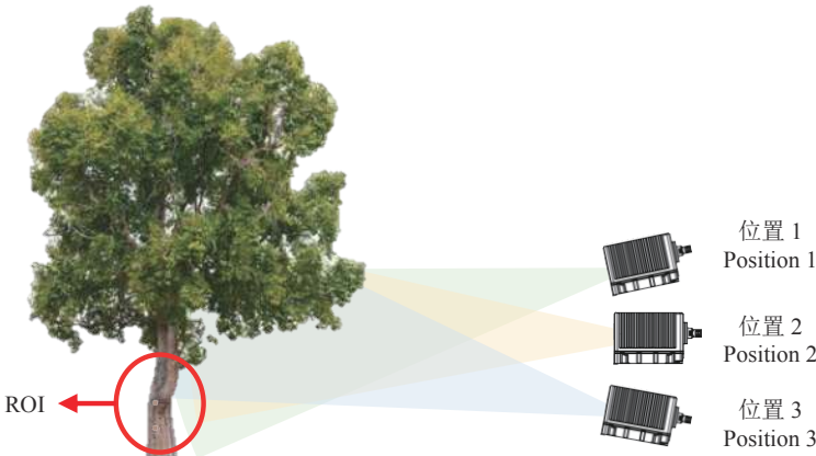
图 4 不同位置的 LiDAR 扫描植物 Fig. 4 Scanning plants by LiDAR at different positions
