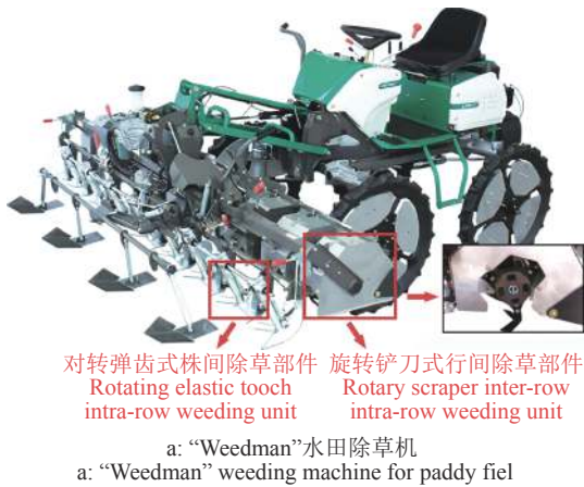
图 6 OREC 公司研制的“Weedman”水田除草机
