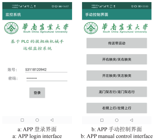
图 6 远程监控系统 Android 手机 APP 客户端 Fig. 6 The android mobile APP client of remote monitoring system
