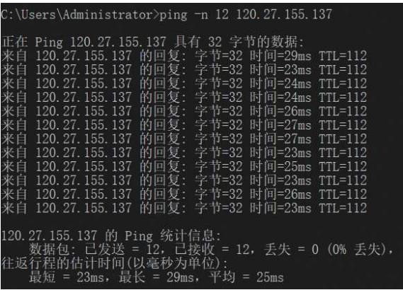
图 7 互联网 Ping 指令测试 Fig. 7 Internet Ping command test
