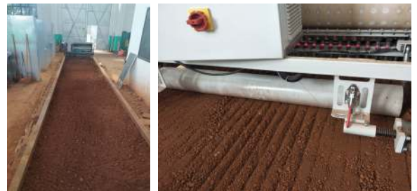
a: 土槽 a: Soil trough
