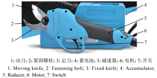
图1 电动修剪机结构示意图
