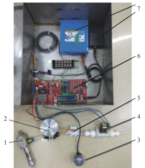
1: 气力引射式施肥器; 2: 机电式流量调节阀; 3: 速度传感器; 4: 电磁阀; 5: 涡轮流量计; 6: 单片机; 7: 电源
