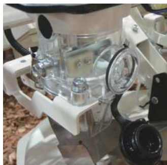
b: 水平圆盘式排种器
